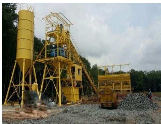
Trạm trộn di động công suất 75 m 3 /h
