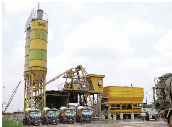
Trạm trộn An Bình công suất 60 m 3 /h
