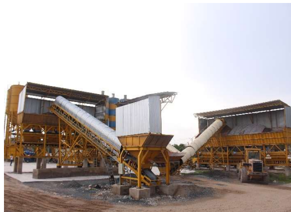
Trạm trộn bê tông công suất 75m 3 /h
