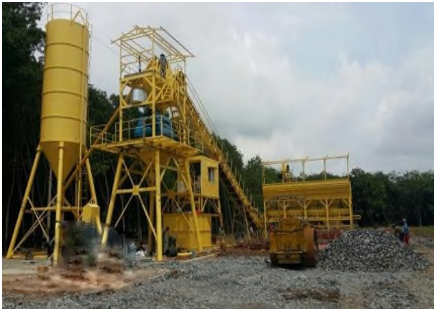
Trạm trộn di động công suất 75 m 3 /h
