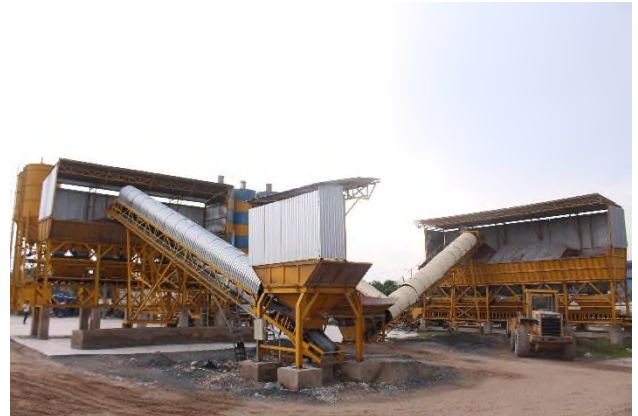
Trạm trộn bê tông công suất 75m 3 /h
